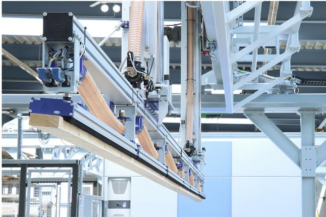
Greifsysteme FMP-S beim lagenweisen Stapeln von Konstruktionsholz
